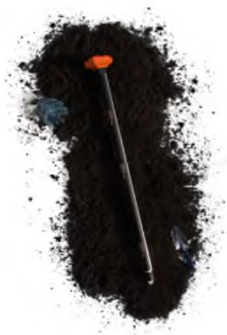
Рисунок 1.10 – Приклад сенсору який застосовується для отримання даних про кількість азоту, фосфору та інших речовин у ґрунті [17]
