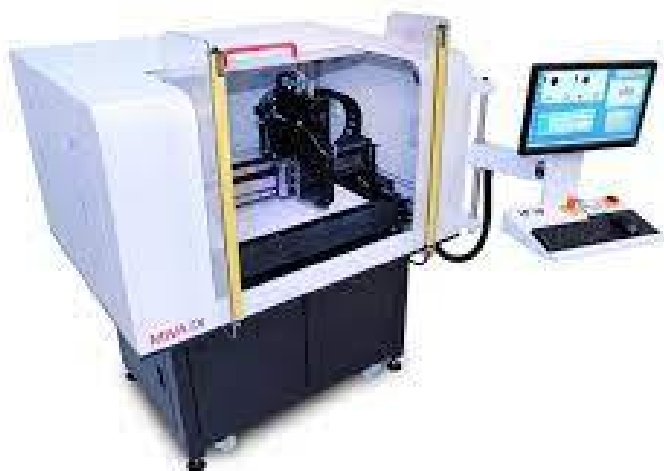
Рисунок 1.12 – Лазерна установка для прямого експонування ДП
