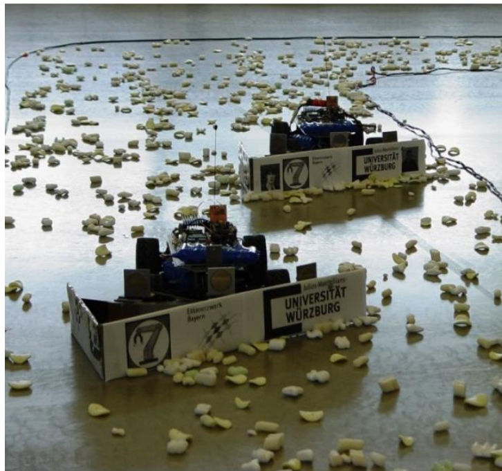
Рисунок 1.10 – Роботи кооперативно виконую завдання з розчищення поверхні [13]
