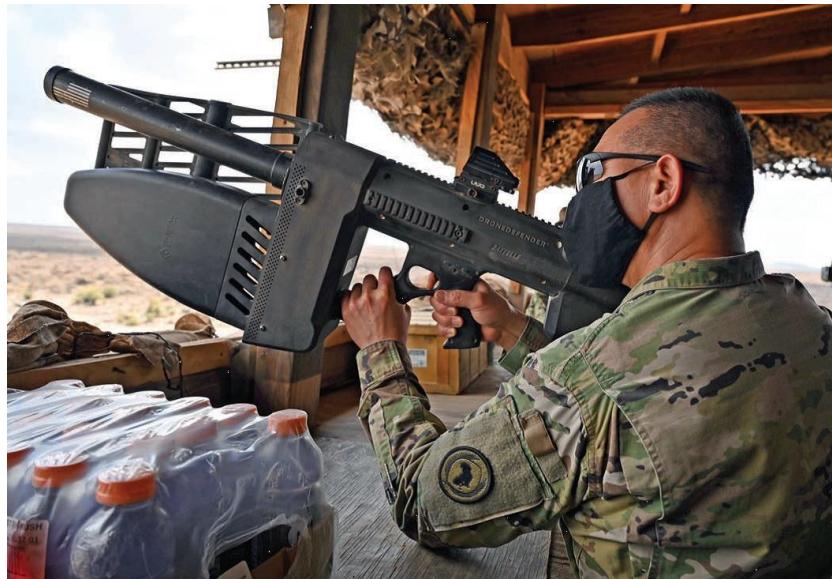
Рисунок 5.2 – Застосування мобільного засобу РЕБ для подавлення GPS сигналу дронів
