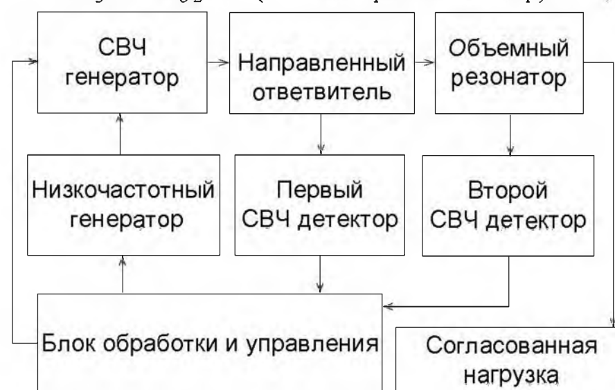
Рис. 1. Структурная схема измерения добротности.
