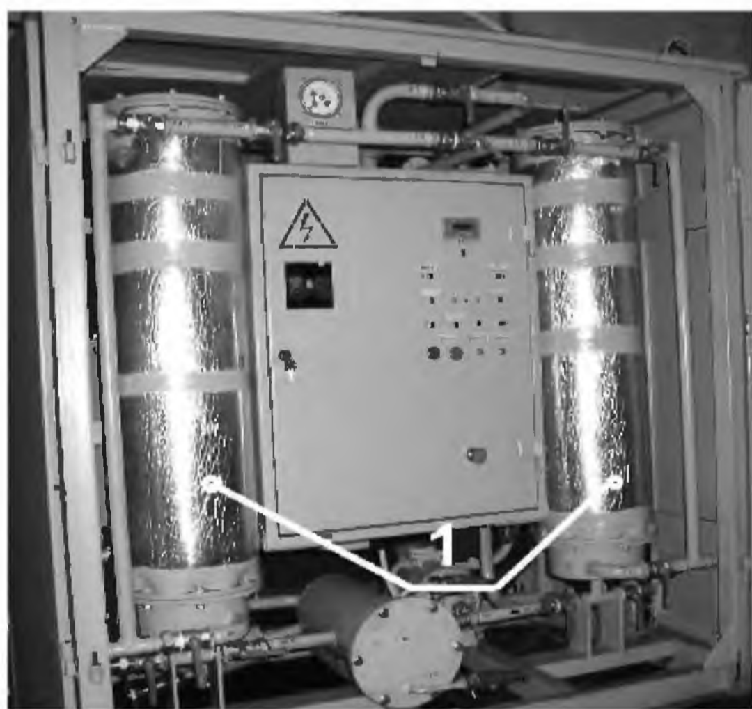
Рис. 3 Установка для ускоренной регенерации трансформаторного масла: 1 – адсорберы.
