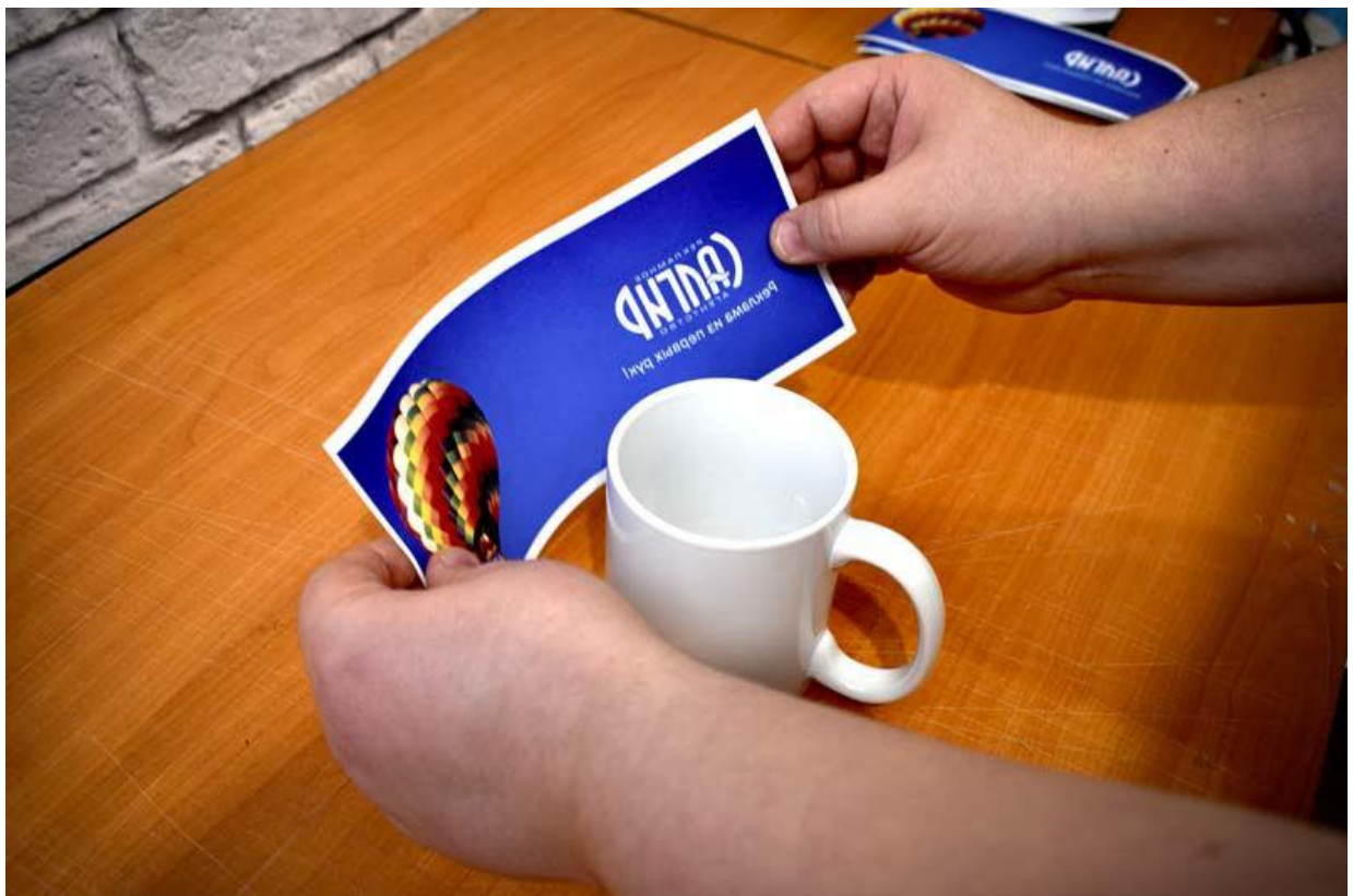
Рисунок 3.6 – Монтаж паперу на кухоль
