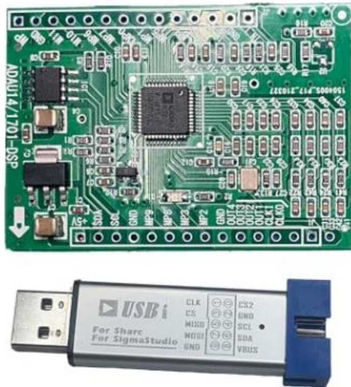
Рисунок 2.5 – Використаний цифровий сигнальний процесор ADAU1401
