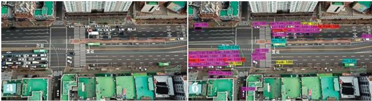
Рисунок 3.5 – Зображення отримане з БПЛА – а; результат виявлення об'єктів з зображення – б
