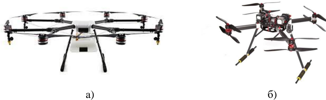
Рисунок 1.5 – Компоновочні схеми 8-коптера: а – класична, б – коаксильна
