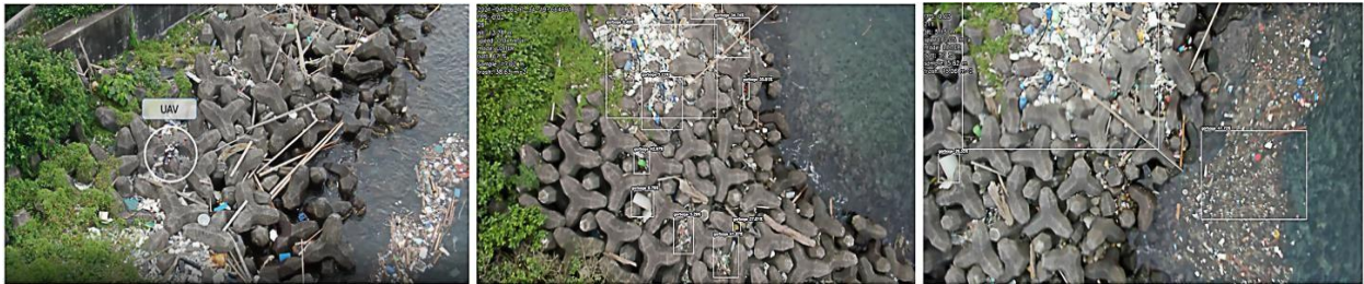
Рисунок 3.7 – Результати виявлення сміття по запису відеокамери з БПЛА
