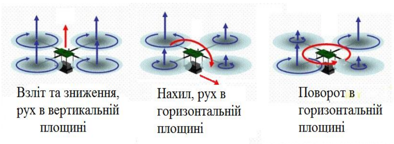
Рисунок 2.2 – Принцип керування 4-коптером
