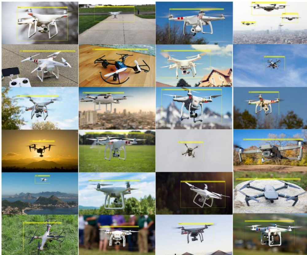
Рисунок 3.4 – Результати адаптованого алгоритму YOLOv3 для виявлення БПЛА
