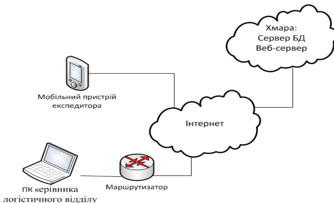
Рисунок 7.1 – Схема підключення технічних засобів
