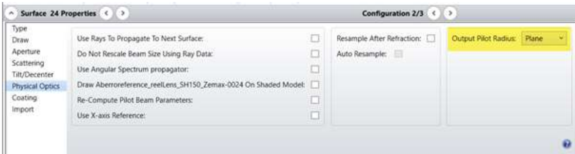
Рисунок 3.13 – На поверхні вихідний пілотний радіус примусово має значення Plane
