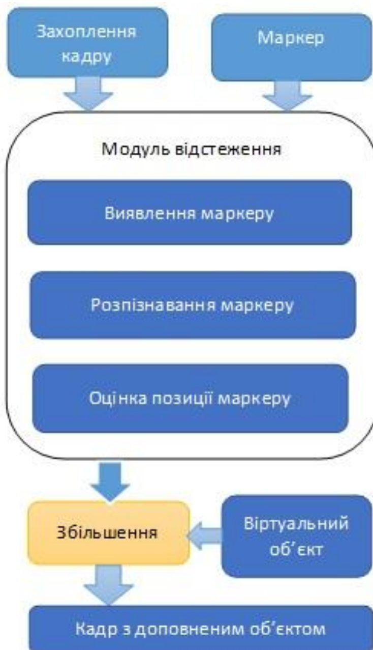
Рисунок 2.6 - Спрощена схема AR-системи
