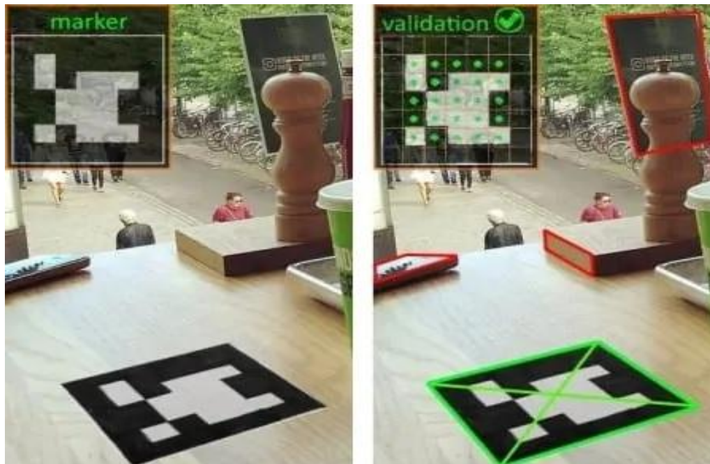
Рисунок 2.7 - Сцена з двійковим маркером (ліворуч) та виявленим маркером (праворуч)
