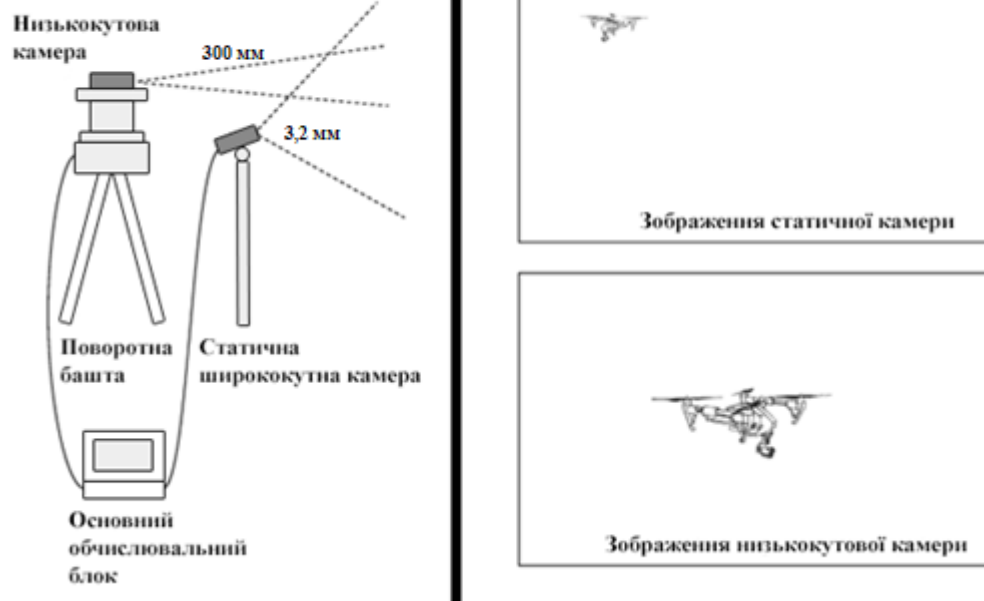
Рисунок 2.13 – Загальне налаштування системи відстеження дронів
