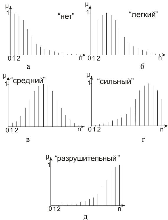
Рисунок 3 - Нечеткое множество состояний объекта: а – не имеющего дефектов; б– имеющего легкий дефект; в– имеющего средний дефект; г – имеющего сильный дефект; д – имеющего разрушительный дефект
