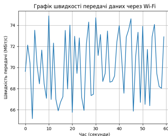
Рисунок 3.8 – Графік швидкості передачі даних з модуля LoLin v3 NodeMcu Lua Wi-Fi ESP8266 CH340 через локальну мережу Wi-Fi на сервер MQTT Eclipse IoT Mosquitto
