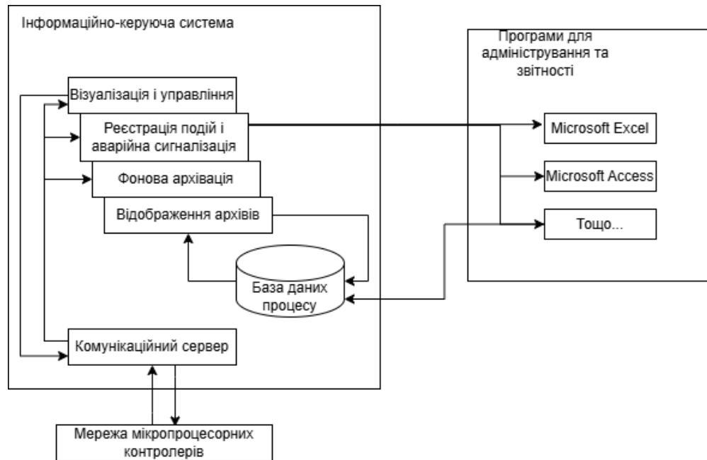
Рисунок 1.4 – Структуру збору даних і оперативного диспетчерського управління SCADA-системи
