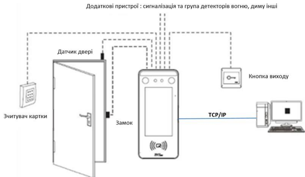
Рисунок 1.2 – Структурна схема системи контролю доступу з пристроєм безконтактної біометричної ідентифікації по лицю та долоні
