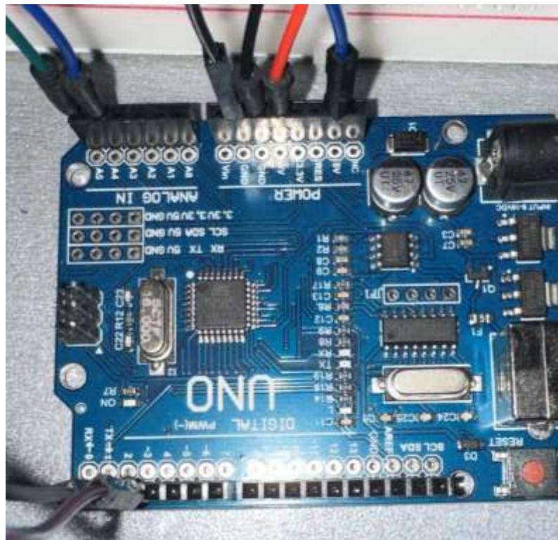
Рисунок 4.6 – Arduino UNO після підключення модуля SIM800L на макеті
