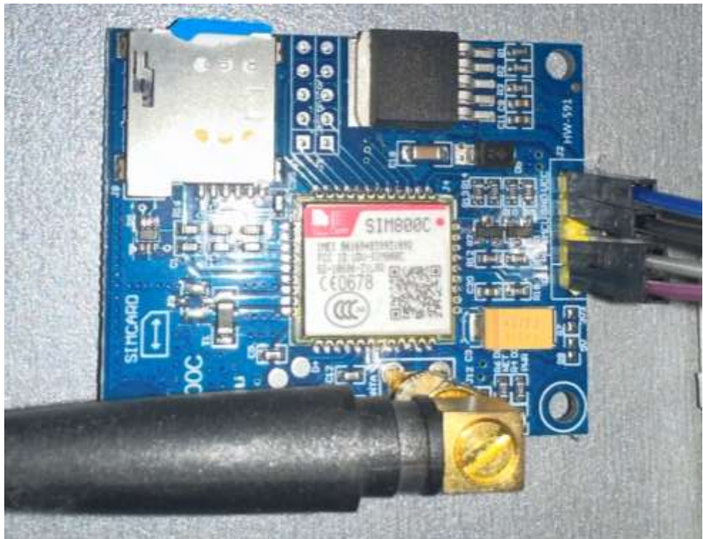
Рисунок 4.5 – Підключення модуля SIM800L на макеті
