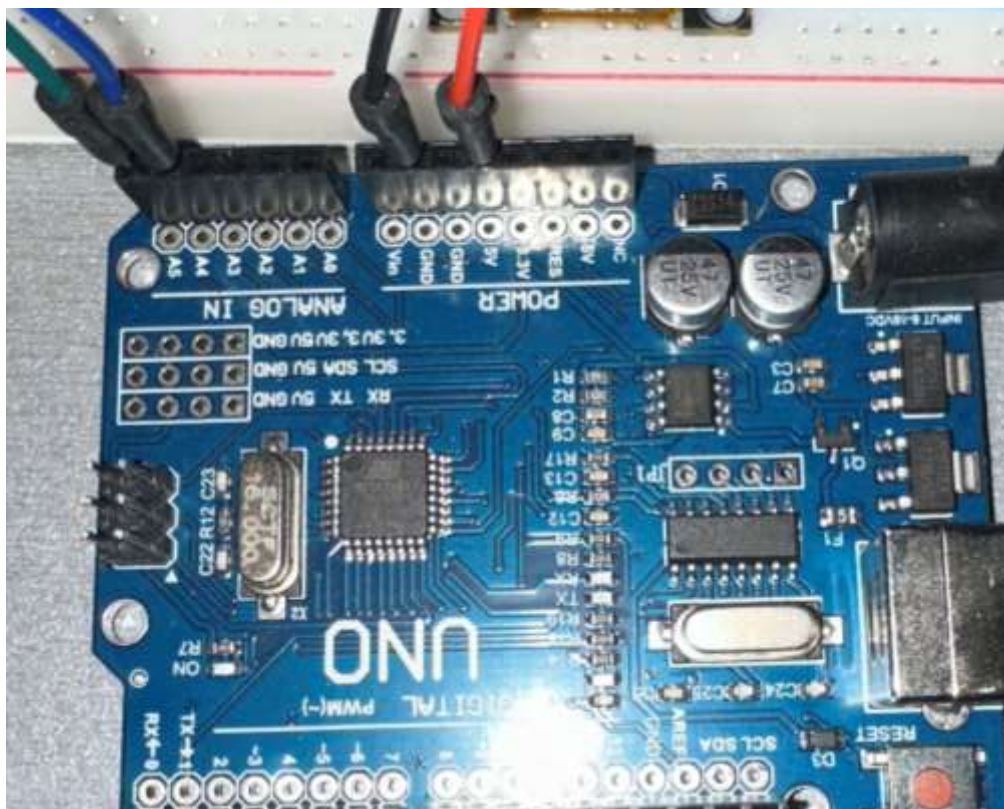
Рисунок 4.3 – Arduino UNO після підключення OLED дисплею на макеті
