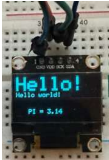
Рисунок 4.12 – Результат роботи тестового скетчу для OLED дисплею
