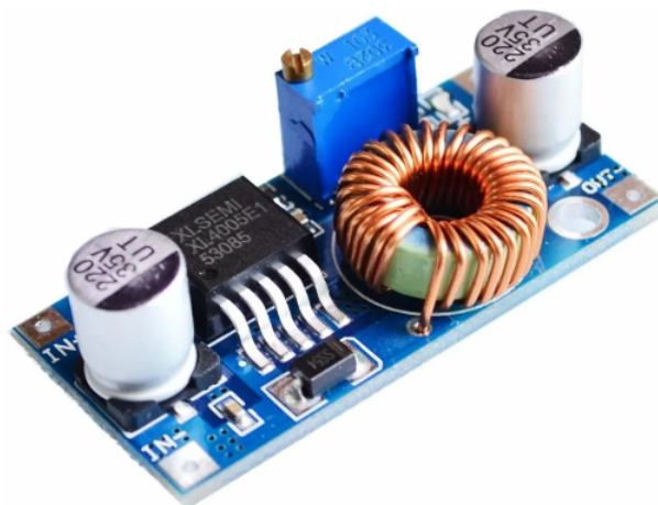
Рисунок 12 – понижуючий DC-DC перетворювач XL4005 5A
