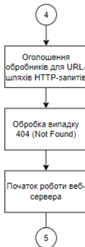
Рисунок 3.5 - Блок-схема налаштування веб-сервера та обробка запитів
