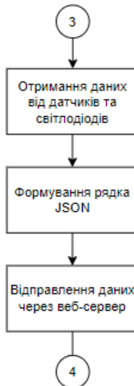
Рисунок 3.4 – Блок-схема роботи функції sendSensorData
