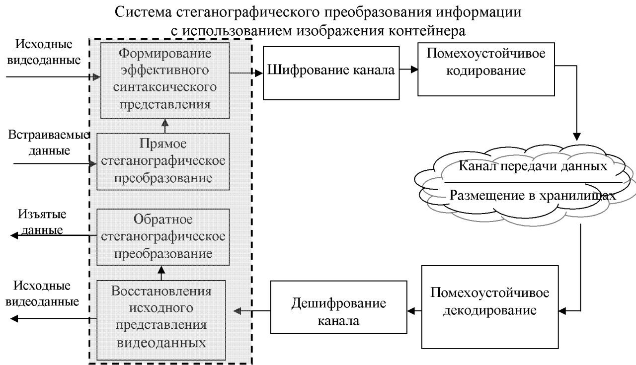
Рис 2.7. Структурно-функциональная схема обработки и передачи видеоданных при стеганографическом встраивании
