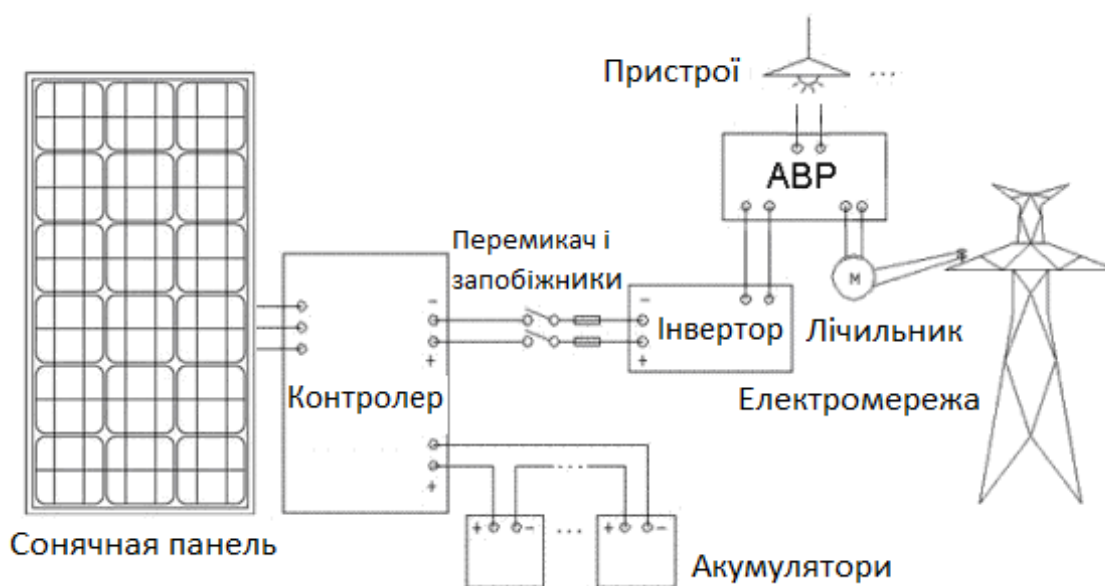
Рисунок 2.1 – Сонячна батарея (з акумуляторами) і комутація з мережею.
