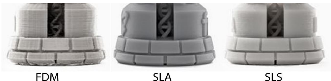
Рисунок 2 – Якість відтворення деталі при різних видах 3D друку
