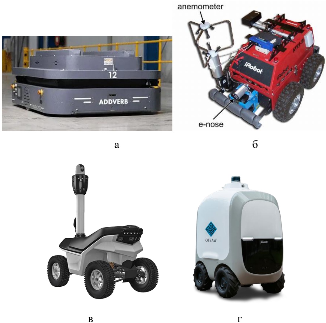
Рисунок 1.1 – Вигляд колісних мобільних роботів: а - робот для переміщення, комплектування та сортування «Дупато»[6], б - робот моніторингу забруднення «Rasmus» [7], в - охоронний патрульний робот «S5.2» [8], г - робот-кур'єр «Camello» [9]
