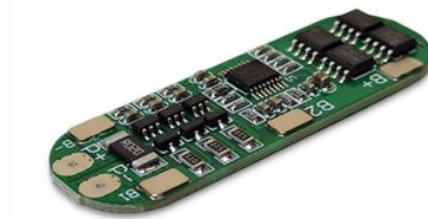
Рисунок 2.4 – Модуль захисту для акумуляторів НХ-3S-ЖНА10 [31]
