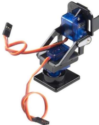
Рисунок 2.3 – Штати нахилу та панорамування з серводвигунами SG90 [29]
