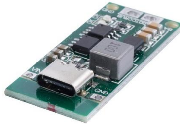
Рисунок 2.5 – Модуль заряду трьох акумуляторів типу 18650 з USB Type-C [32]
