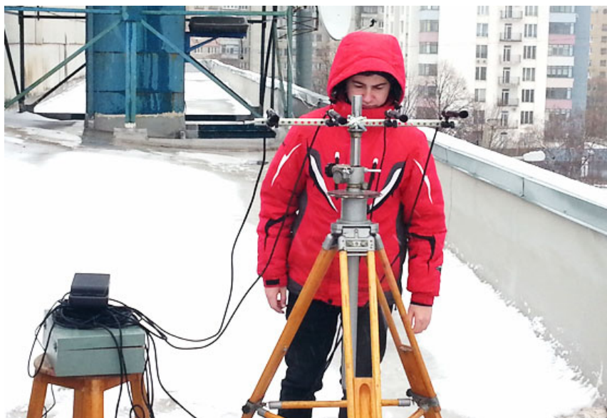
Рисунок 5.4 – Мікрофонна решітка на поворотному пристрої з відліковою кутомірною шкалою.
