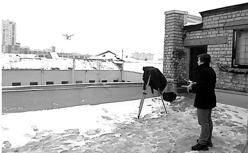
Рисунок 5.19 - Зависання квадрокоптера DJI Phantom 3 під час виміру характеристики пеленгації.
