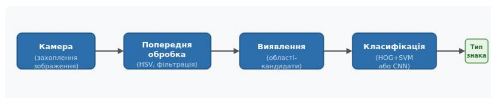
Рисунок 1 – Блок-схема системи розпізнавання дорожніх знаків
