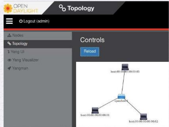
Рисунок 2 – Вкладка топології в контролері OpenDaylight
