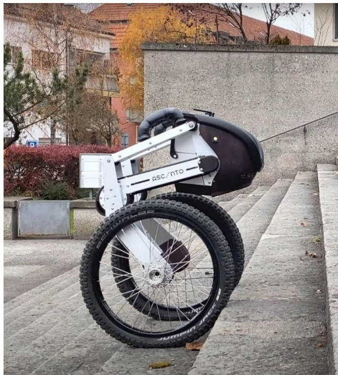
Рисунок 1.15 – Робот Ascento Pro здатен долати сходи «стрибками» [22]
