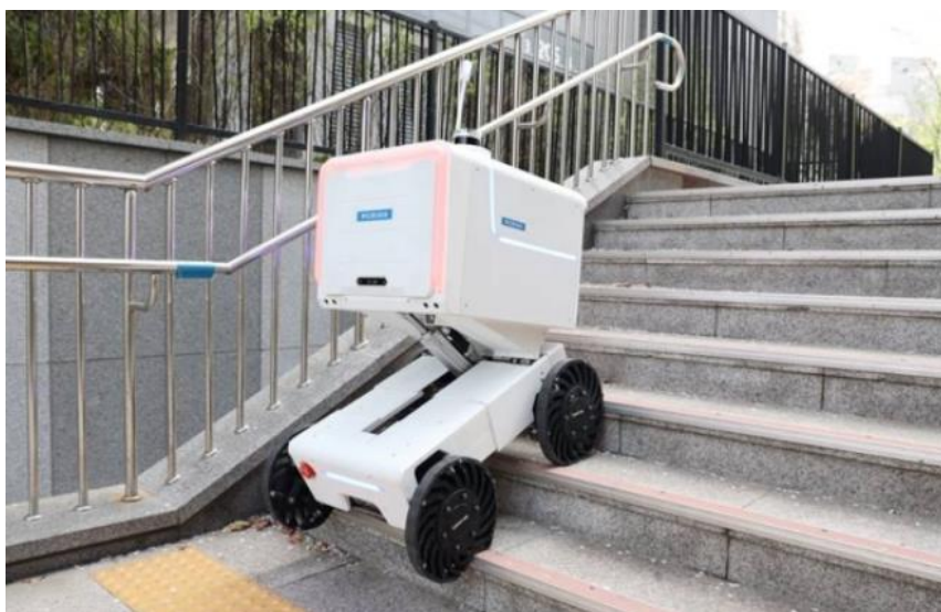
Рисунок 1.8 – Прототип робота курера від Mobinn з гнучкими шинами
