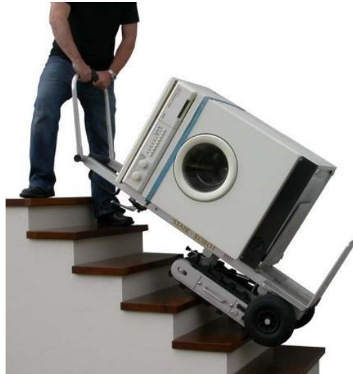
Рисунок 1.3 – Моторизований візок AATA International Stair-Robot Express
