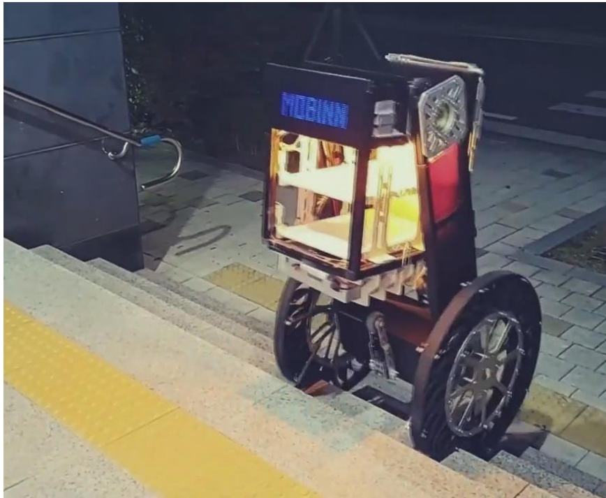
Рисунок 1.7 – Перший прототип робота Mobinn з гнучкими шинами
