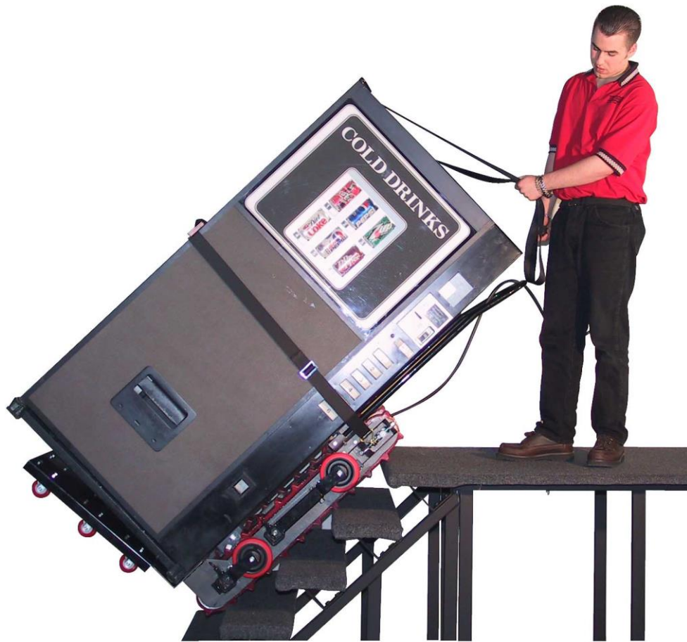
Рисунок 1.17 – Пересування вантажу сходами візком Hercules Steprider
