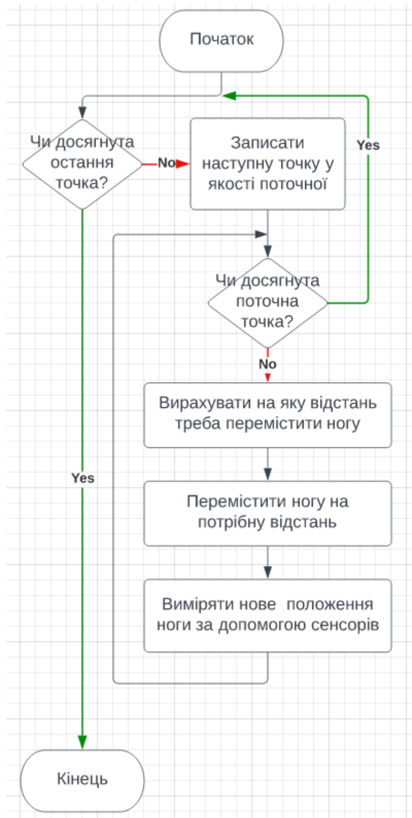
Рисунок 4.7 – Підпрограма переміщення пари ніг крокуючої платформи
