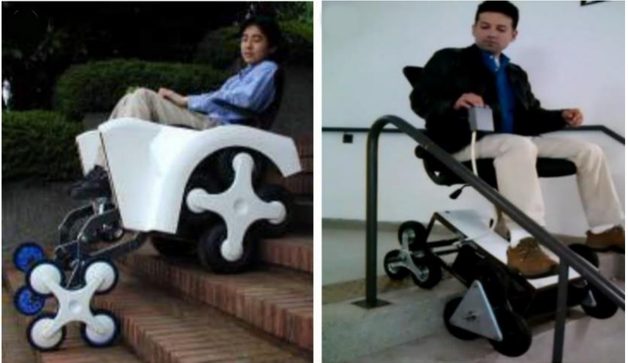
Рисунок 1.11 – Механізм підйому по сходах на базі двох або більшої кількості пар груп коліс
