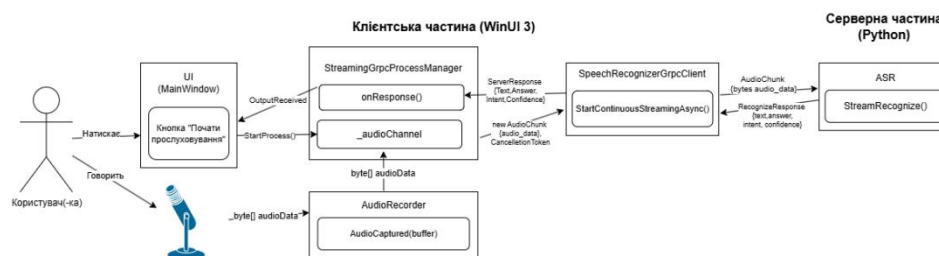
Рисунок 3.4 – Діаграма взаємодії між компонентами клієнтської частини під час потокового передавання аудіоданих
