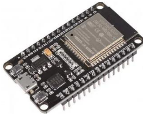
Рисунок 3.2 - Плата для розробки ESP32
