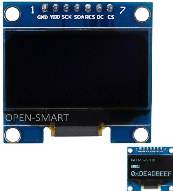
Рисунок 3.5 - OLED дисплей без I2C шини
