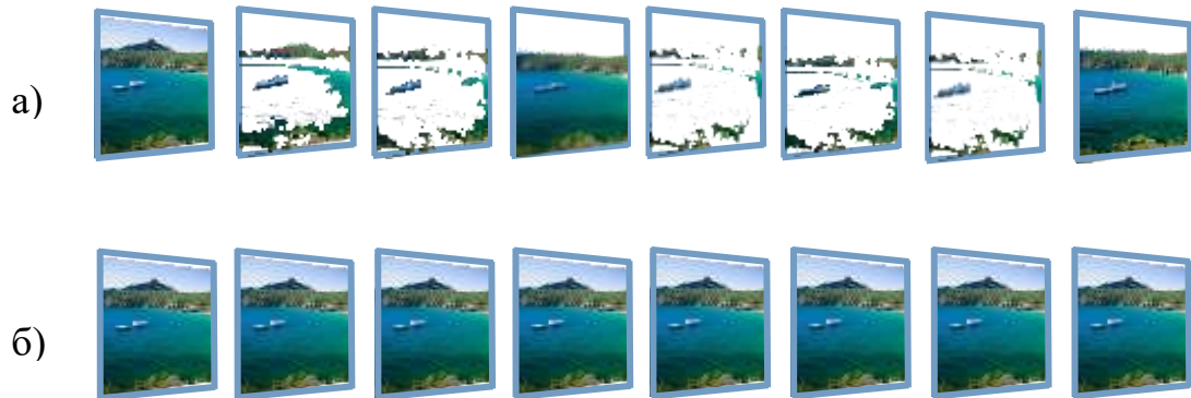
Рисунок 1.3 – Приклади фрагменту відеоряду, відносно якого було виконано процедури усунення часової надмірності а) та відеоряду, де часову надмірність скорочено не було
