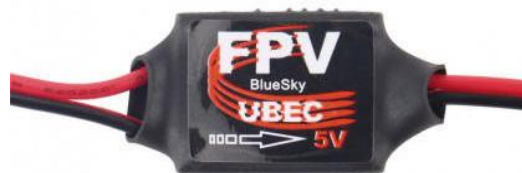
Рисунок 2.6 – Знижувальні перетворювачі напруги 5В 3А
