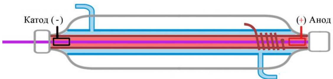
Рисунок 1.7 – Схематичне зображення CO 2 лазерної трубки
