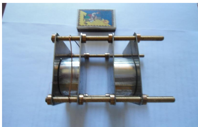
Рисунок 5.8 – Фотографія двох постійних магнітів Nd-Fe-B з елементами їх кріплення. Зазор між ними (близько 20 мм) слугує для встановлення в ньому мідної склянки з модельним розчином
