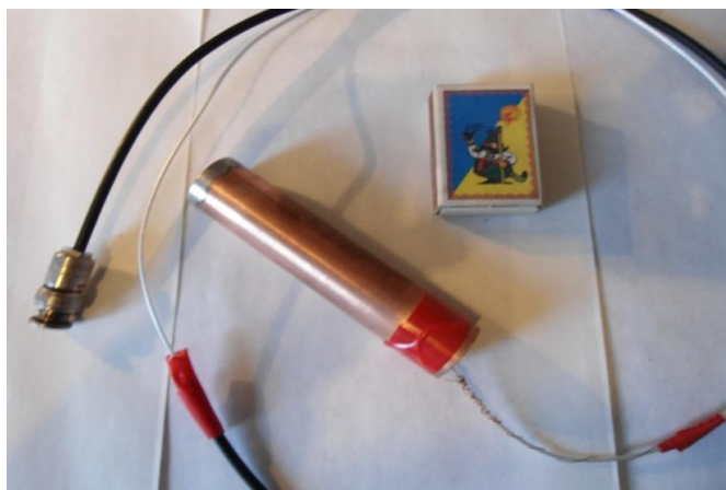
Рисунок 5.7 – Зовнішній вигляд мідної склянки для модельного розчину із встановленими всередині нього зондами та електричним кабелем для вимірювання напруги на зондах за допомогою селективного вольтметра (на фотографії не показано)
