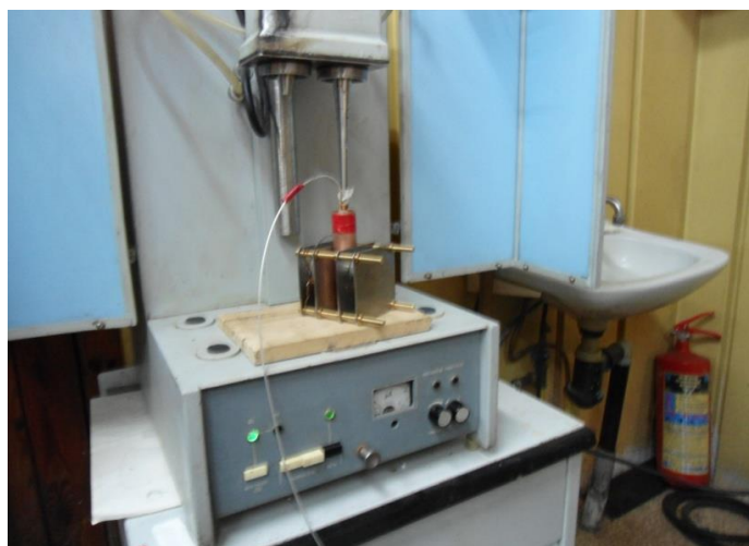
Рисунок 5.6 – Зовнішній вигляд пристрою для збурення змінного електричного струму в модельному зразку біологічного середовища (розчин NaCl ) з акустомагнітним впливом на нього
