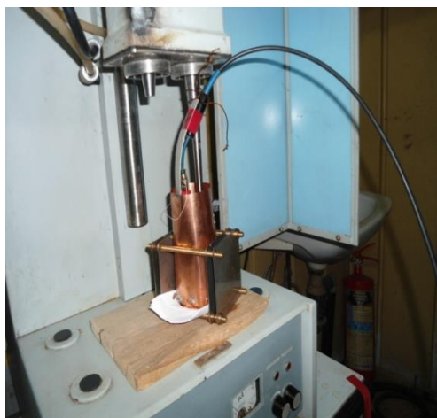
Рисунок 5.1 – Зовнішній вигляд генератора ультразвуку та циліндричного електромагнітного екрана, всередині якого встановлено посудину з колоїдним розчином магнітних наночастинок
