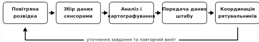
Рисунок 1 – Інформаційний цикл застосування дрона під час надзвичайної ситуації
