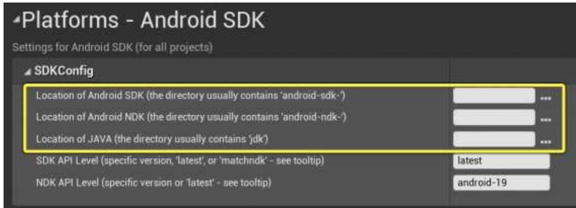
Рисунок 4.4 – Ручне налаштування шляху до компонентів [1]
