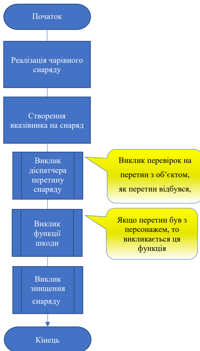
Рисунок 4.33 – Алгоритм створення снаряду та його взаємодія
