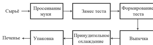
Рис. 1. Обобщенная модель технологического процесса производства печенья
