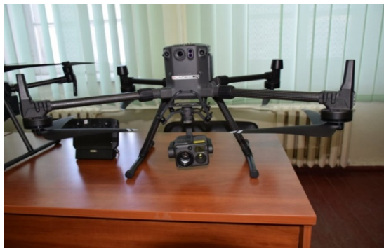
Рисунок 2 – Дрон оснащений оптичними датчиками для пошуку ВВП
