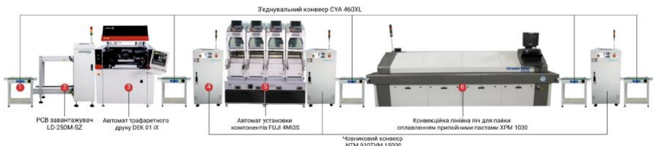
Рисунок 1 – Гнучка автоматизована лінія SMT-монтажу
