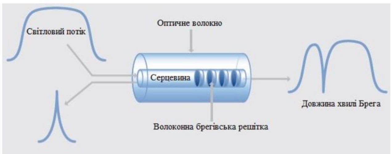
Рисунок 1.4 – Принцип роботи волоконного сенсора на основі решітки Брегга
