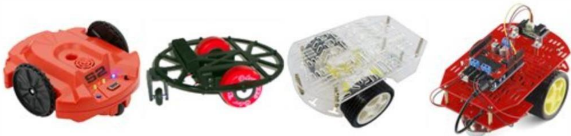
Рисунок 1.5 – Платформи на двох ведучих колесах та одному колесі «холостого ходу»
