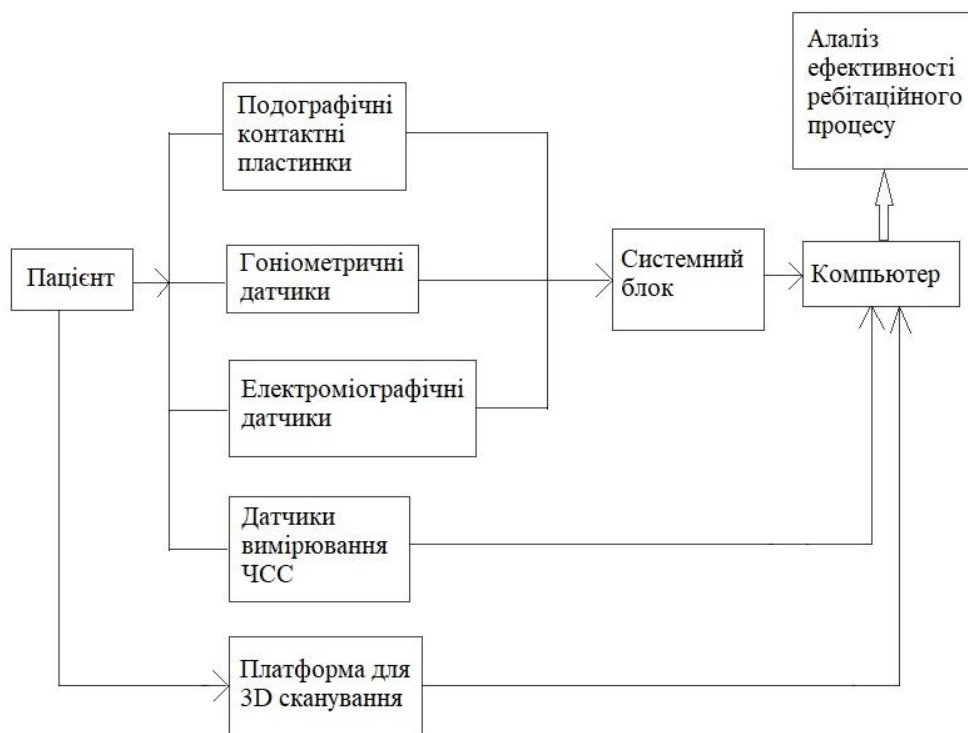
Рис. 1. Схема комплексної діагностики ОДА під час ходьби
