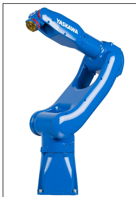
Рисунок 1.4 – Зображення маніпулятора Yaskawa Motoman GP8
