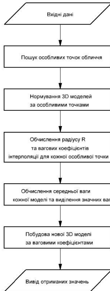
Рисунок 2.5 - Схема алгоритму формування індивідуальної 3D моделі обличчя
