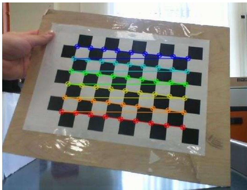
Рисунок 5 – Калібрувальний шаблон із знайденими кутами
