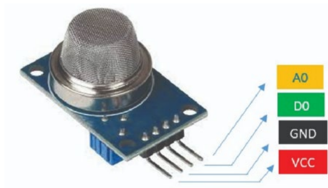
Рисунок 2.5 – Зовнішній вигляд датчика диму MQ-2
