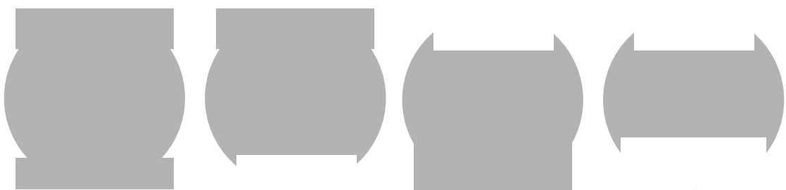
Рисунок 2.7 – Поперечний переріз різних форм паяного з'єднання BGA-кульки
