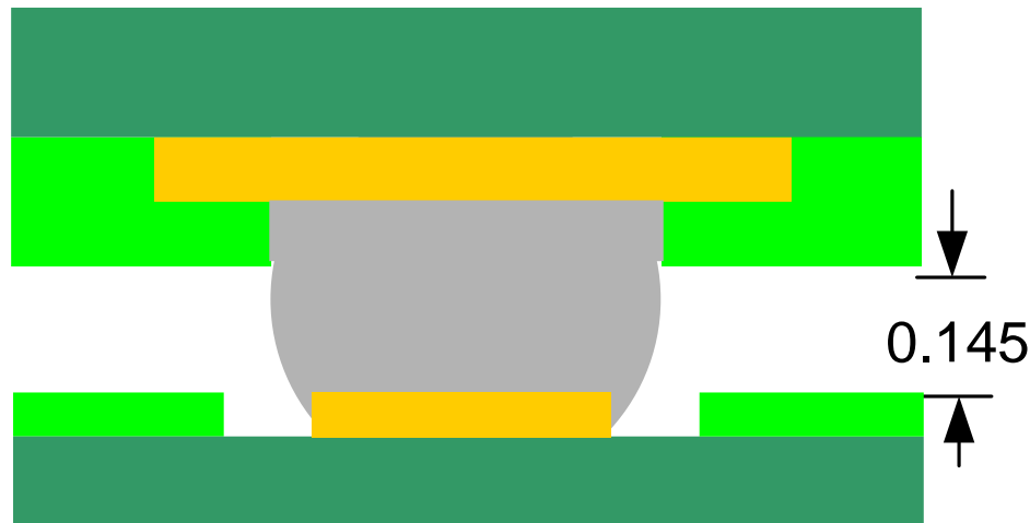
Рисунок 2.4 – Монтажна висота BGA-кульки 0,145 мм.
