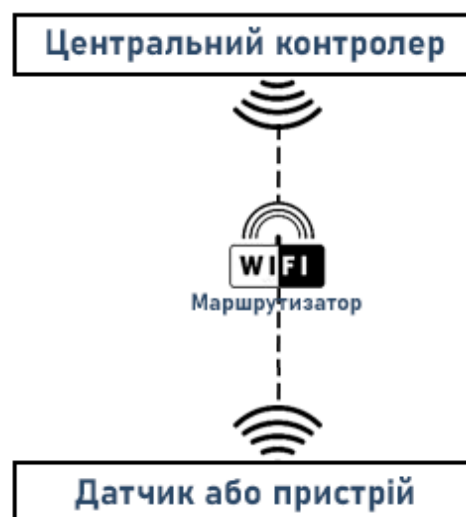
Рисунок 2.3 – Модель передачі даних з використанням стандарту WiFi у системі розумний будинок
