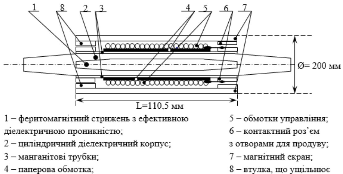
Рис.2. Конструкція перспективного феритового фазообертача з ефективною діелектричною проникністю
