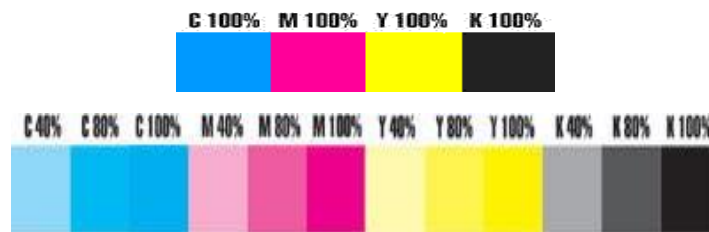
Рисунок 10.1 – Шкали оперативного контролю друкарського процесу: вгорі «скорочена», внизу із додатковими полями контролю розтискування
