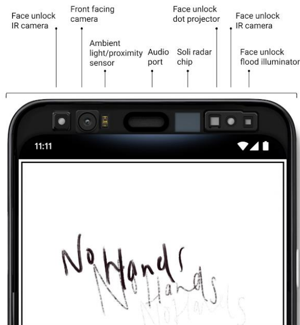
Рисунок 1.7 – Розташування сенсорів на передній панелі Google Pixel 4
